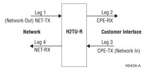
Figure 31. Sectionalized Analysis of the DS1 Interface
