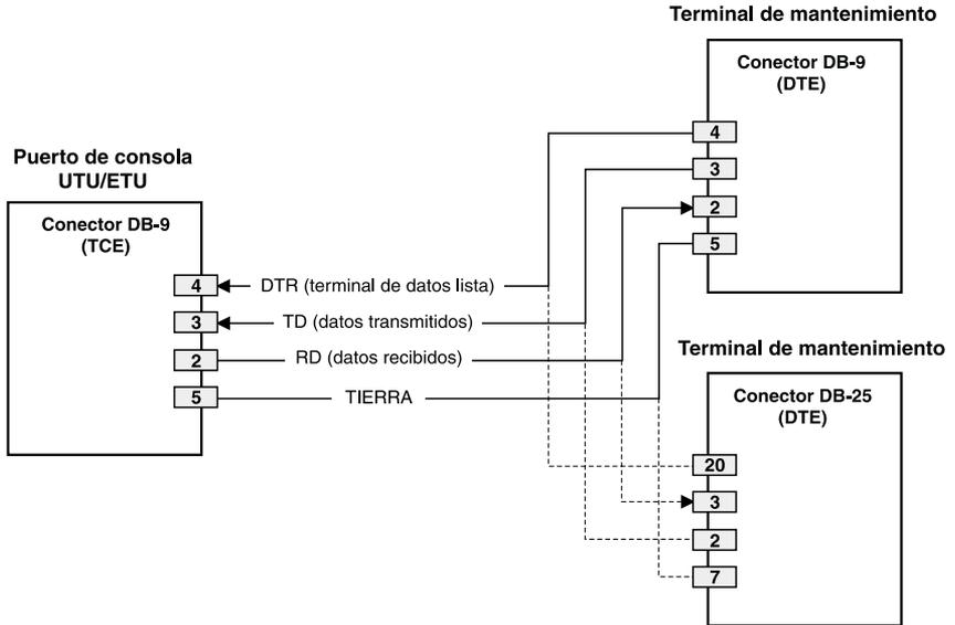
*Correspondencia de terminales o patillas de conectores de puerto de consola y terminal de mantenimiento UTU/ETU*
